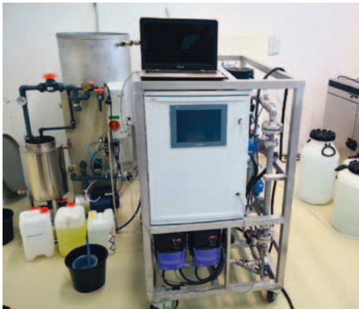
Testování Keramických membrán v laboratorních podmínkách
