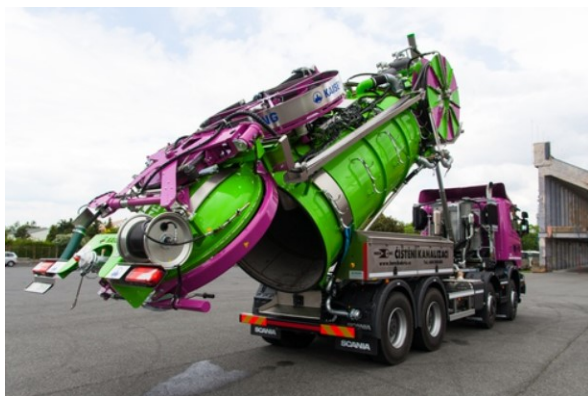
Vůz na čištění kanalizace 1
