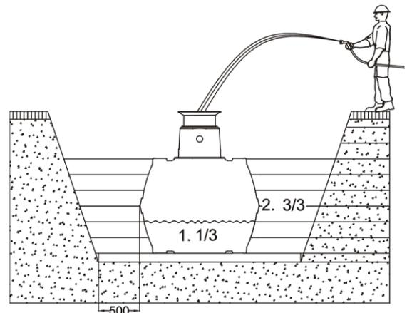
Nádrž obsypávejte po jednotlivých vrstvách - maximálně 30 cm jedna vrstva - a současně napouštějte nádrž vodou. Jednotlivé vrstvy zhutněte. Pro zhutnění používejte výhradně manuálních (ručních) strojů a dbejte zvýšené opatrnosti, abyste nepoškodili nádrž. Zhutnění obsyp musí být provedený minimálně do vzdálenosti 500 mm ve všech směrech od nádrže.
