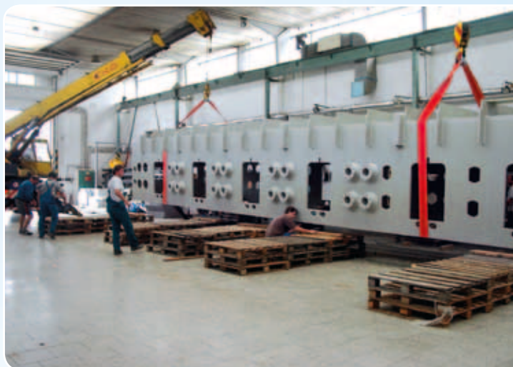
Polypropylenová mořicí linka pro galvanizovnu
