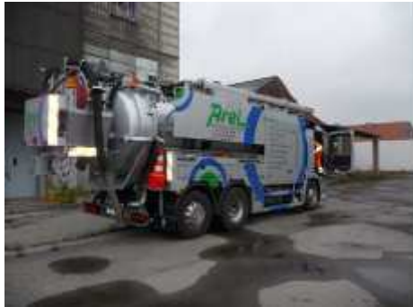
Vůz na čištění kanalizace
