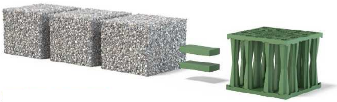
Obrázek č. 2: Potrubní příkopy, příp. příkopy vyplněné štěrkem dokážou pojmout jen asi 30 % vody ze svého objemu. Výkop zeminy proto musí být 3x větší než je potřebný akumulací objem vody. Znamená to hodně místa, které často není na urbanizovaném území k dispozici.
