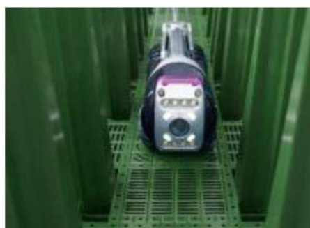
Obrázek č. 2: Ukázka kamerové zkoušky v bloku AS-Rigofill ST
