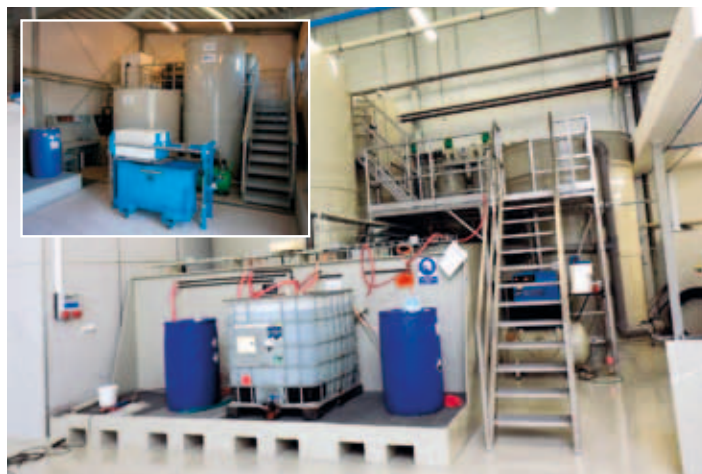
Foto: technologie čištění odpadních vod založená na sedimentačních procesech
