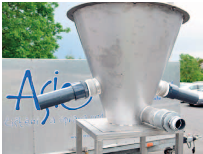
Obr. 7: Testovací nátoková kuželová komora dehydrátoru
