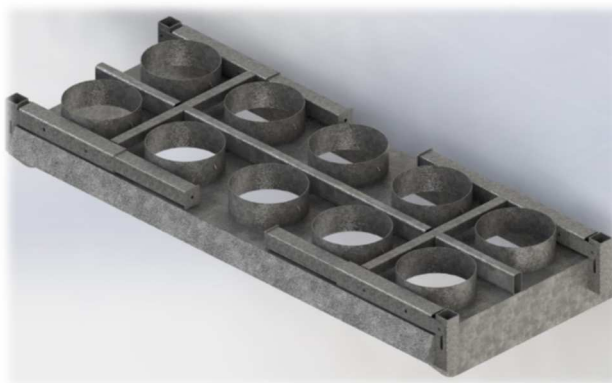
Plnicí lavice ve smontovaném stavu pro přepravu
