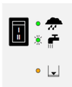
Maintenance mode „Mains water mode“
