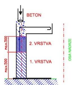
II. Fáze - po zatuhnutí 1. vrstvy betonovat 2. vrstvu rovnoměrně po celém obvodu vždy max. do výšky 500mm.
