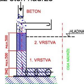
II. Fáze - po zatuhnutí dna betonovat 1. vrstvu max. výšky 500 mm. Po zatuhnutí 1. vrstvy betonovat 2.vrstvu stejným způsobem.
