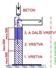
III. Fáze - po zatuhnutí předchozích vrstev betonovat 3. a další vrstvy rovnoměrně po celém obvodu vždy max. po 500mm.
