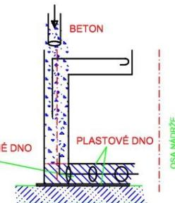
I. Fáze - vylít beton do vyarmovaného dna provádět rovnoměrně po celém obvodu. Beton se do dna vlije pomocí dír ve spodní části stěny nádrže. Tyto díry zůstanou zalité betonem. V další betonáži pokračujte až po zatuhnutí dna.
