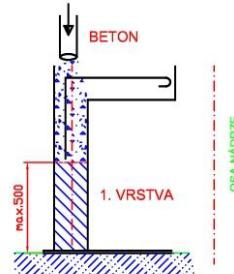
I. Fáze - 1. vrstvy betonovat rovnoměrně po celém obvodu vždy max. do výšky 500mm.
