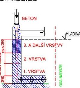
III. Fáze - po zatuhnutí předchozích vrstev betonovat 3. a další vrstvy výšky max. po 500mm.
