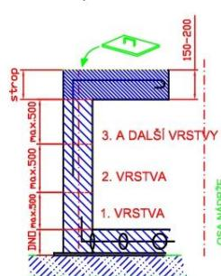
IV. Fáze - betonáž stropu a zarovnání povrchu. Strop betonovat samostatně po zatuhnutí poslední vrstvy!!!
