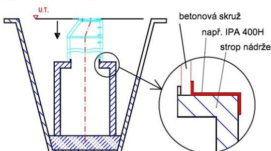
Izolaci stropu provádět po zabetonování stropu a po osazení šachetových skruží. Izolační fólie (např. IPA) přiložit na strop nádrže a konce natavit na stěnu nádrže a komínek.
