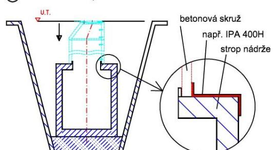
Izolaci stropu provádět po zabetonování stropu a po osazení šachetových skruží. Izolační folii (např. IPA) přiložit na strop nádrže a konce natavit na stěnu nádrže a komínek.
